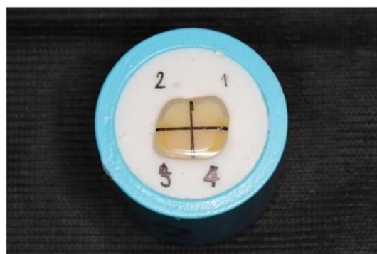
รูปที่ 2 ตำแหน่งที่ใช้ในการทดสอบวัดค่าความแข็งแรงผิวของชิ้นงานในแต่ละซี่ Figure 2 The position used for testing the surface hardness of each tooth.
