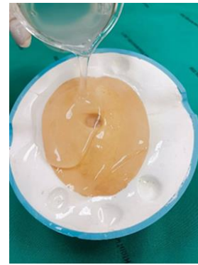
รูปที่ 13 แสดงการราดพอลิยูรีเทนเหลวลงบนแบบจำลองหลัก Figure 13 shows liquid polyurethane poured onto mater cast.
