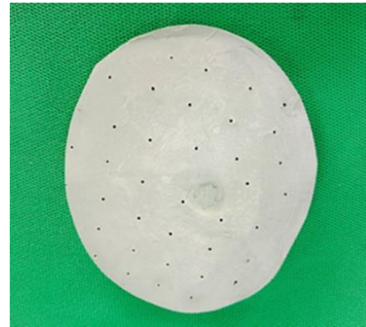
รูปที่ 9 แสดงแบบจำลองที่มีรูทะลุเล็กกระจายอยู่ทั่ว ๆ ไป Figure 9 displays a cast with microscopic perforations throughout its surface.
