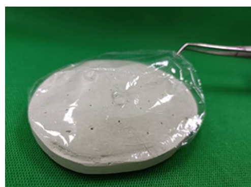
รูปที่ 9 แสดงแบบจำลองที่มีรูทะลุเล็กกระจายอยู่ทั่ว ๆ ไป Figure 9 displays a cast with microscopic perforations throughout its surface.
