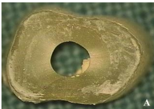
รูปที่ 2 ภาพจากกล้องไมโครสโคปกำลังขยาย 25 แสดงลักษณะการแตกหักแบบผสม (A) และการแตกหักแบบเชื่อมแน่น (B)
