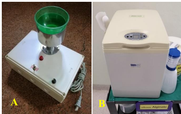
รูปที่ 1 เครื่องผสมกึ่งอัตโนมัติที่ประดิษฐ์ขึ้น (A) และเครื่องผสมอัตโนมัติแบบหมุนเหวี่ยง (B)
