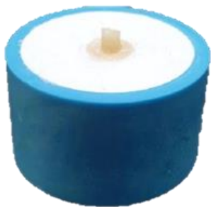
รูปที่ 1 ชิ้นงานตัวอย่างแท่งเรซินคอมโพสิตยึดติดกับเรซินมอดิฟายด์กลาสส์ไอโอโนเมอร์ซีเมนต์
