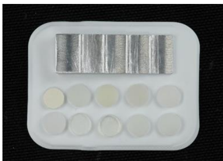
รูปที่ 4 ชิ้นทดสอบและลิ่มโลหะอะลูมิเนียมแบบขั้นบันไดที่วางบนแผ่นเซนเซอร์
