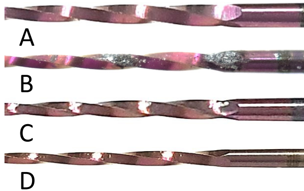
รูปที่ 4 พื้นผิวของเครื่องมือไฮฟเล็กซ์เอ็มภายหลังการแช่เครื่องมือลงในน้ำยาล้างคลองรากฟัน ที่อุณหภูมิ 37° C เป็นเวลา 5 นาที (A) กลุ่มที่ 1 ไม่แช่ลงในน้ำยาล้างคลองรากฟัน (B) กลุ่มที่ 2 น้ำยาล้างคลองรากฟันโซเดียมไฮโปคลอไรด์ ความเข้มข้นร้อยละ 2.5 ซึ่งสามารถสังเกตเห็นการกัดกร่อนบริเวณผิวของเครื่องมือ (C) กลุ่มที่ 3 น้ำยาล้างคลองรากฟันกรดเอทิลีนไดอะมีนเตตราอะซิติกความเข้มข้นร้อยละ 17 (D) กลุ่มที่ 4 น้ำยาล้างคลองรากฟันคลอร์เอ็กซีดินกลูโคเนต ความเข้มข้นร้อยละ 2
