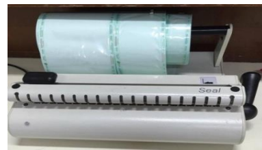
รูปที่ 3 เครื่องปิดผนึกแบบมือกด รุ่น SEAL (Eoronda Spa, Italy)
