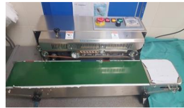
รูปที่ 2 เครื่องปิดผนึกสายพานต่อเนื่องแนวนอน รุ่น FR-900S (M.M.M. Buxabhoy & Co (3MB), India)
