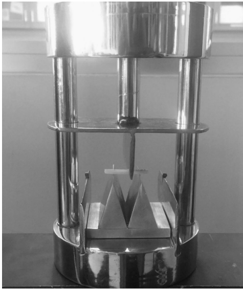
รูปที่ 2 การทดสอบคุณสมบัติดัดขวางแบบ 3 จุด ด้วยเครื่องทดสอบแรงแบบสากล
