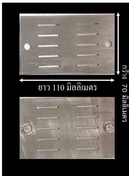
รูปที่ 1 รูปประกอบแสดงลักษณะเบ้าหล่อโลหะแบบแยก 2 ชิ้น (บน-ล่าง)
