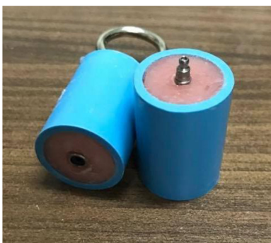
รูปที่ 1 บล็อกอะคริลิกชั้นบนเพื่อเป็นที่อยู่ของเสาเชิง-บล็อกอะคริลิกชั้นล่างใช้ยึดแอนะล็อกรากฟันเทียมชั่วคราวกับสลักยึดรูปทรงกลม
