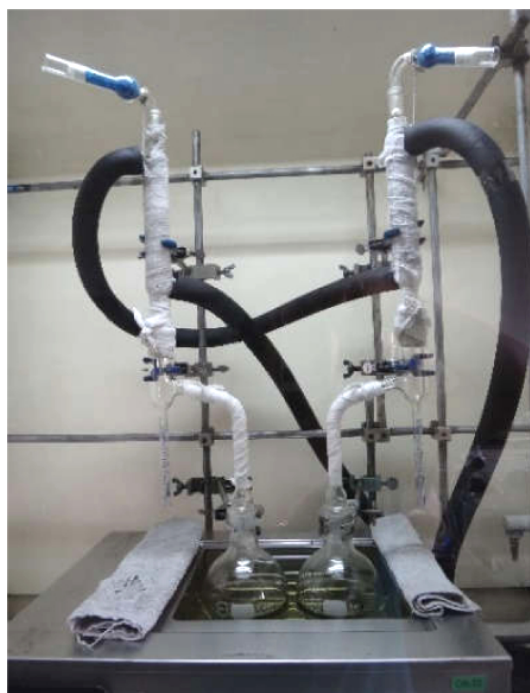
ภาพที่ 2 การหาปริมาณความชื้นด้วยวิธี Azeotropic distillation
