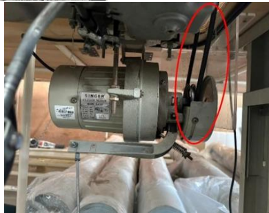
ภาพที่ 2 จุดเสี่ยงของเครื่องจักรเย็บผ้า
