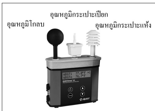
ภาพที่ 3 เครื่องมือตรวจวัดความร้อนชนิดอิเล็กทรอนิกส์ (บริษัท อินโนเวทีฟ อินสตรูเมนต์ จำกัด, ม.ป.ป.)
