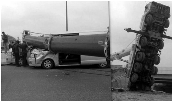
ภาพที่ 1 อุบัติเหตุรถปั้นจั่นล้มคว่ำทับรถตู้ ที่แหลมฉบัง
