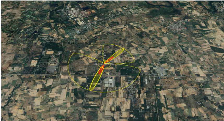
ภาพที่ 2 จำลองการแพร่กระจายของก๊าซมีเทนแบบกลุ่มหมอกก๊าซไวไฟขนาดรั้ว 4 และ 16 นิ้ว
