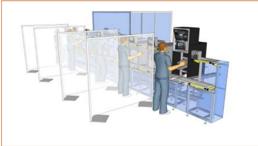
ภาพที่ 1 การติดตั้งฉากโปร่งใสกั้นแยกพื้นที่ทำงาน
