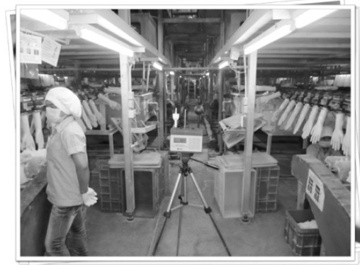
ภาพที่ 4 การตรวจวัดความร้อนในโรงงานผลิตถุงมือทางการแพทย์ ที่มา : http://www.vachiraphuket.go.th/oeh/
