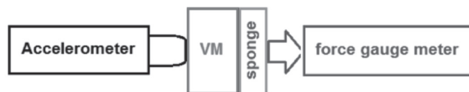
ภาพที่ 12 ทำการจับยึดมอเตอร์กับ เพื่อทดสอบคุณสมบัติของแหล่งกำเนิดแรงสั่น
