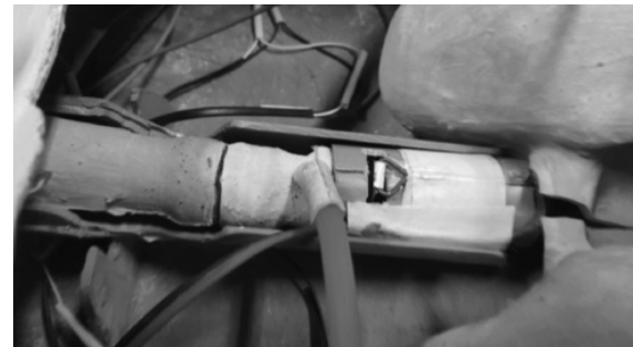
ภาพที่ 3 แสดงด้านในตัวหุ่นจำลอง ท่อหลอดลมคอเทียมต่อกับกระเปาะใส่เสมหะ
