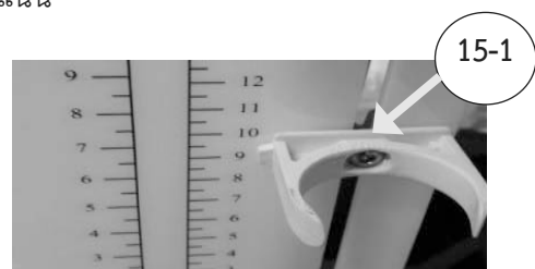
ภาพที่ 15 ปรับด้านบนที่แขวนกระบอกตวงเท่ากับ 10 เซนติเมตร
