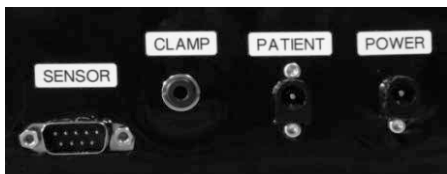
ภาพที่ 30 ป้ายบอกตำแหน่งการเชื่อมต่ออุปกรณ์ เข้ากับกล่องควบคุมหลัก
