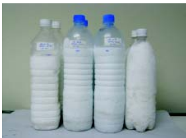
รูปที่ 3 ice pack ที่นำออกจากตู้แช่แข็งที่อุณหภูมิ -28^{\circ}\text{C} ภายในบรรจุแช่แข็งนานประมาณ 30 ชั่วโมง
