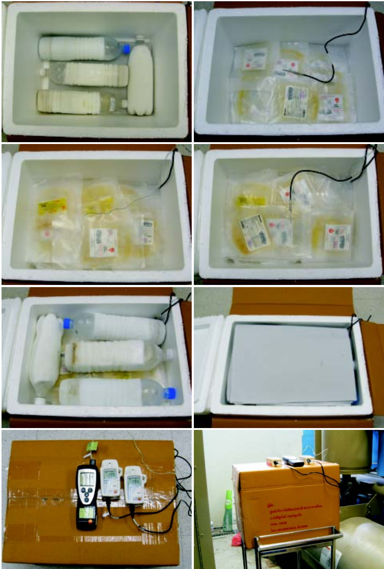
รูปที่ 6 รูปแบบการบรรจุหีบห่อ cryoprecipitate จำนวน 50 ยูนิต ในภาชนะบรรจุโดยใช้ ice pack C
