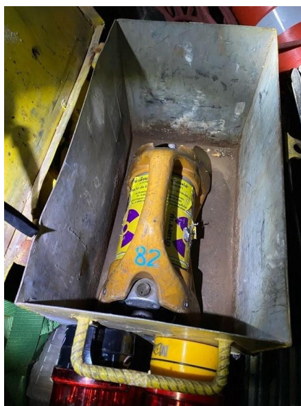
ภาพที่ 2 แสดงเครื่องกำเนิดรังสีแกมมาจาก IR-192 ของสถานประกอบการปิโตรเคมีดังกล่าว
