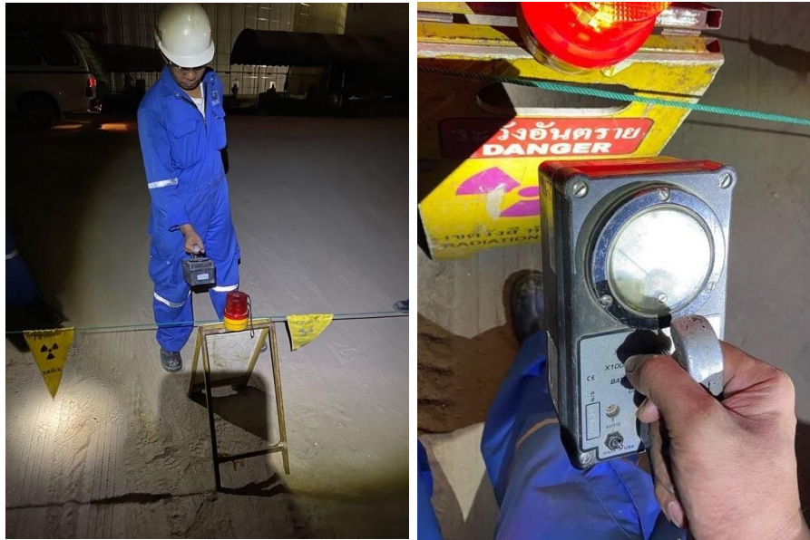
ภาพที่ 3 แสดงบริเวณที่กั้นเชือกธงเตือนเขตรังสี และการวัดรังสีด้วย Survey Meter ทุกครั้งก่อนเริ่มงานของสถานประกอบการปิโตรเคมีดังกล่าว
