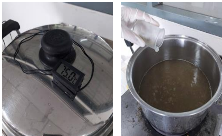
รูปที่ 2 การต้มมอลต์ เพื่อเตรียมน้ำเวิร์ท
