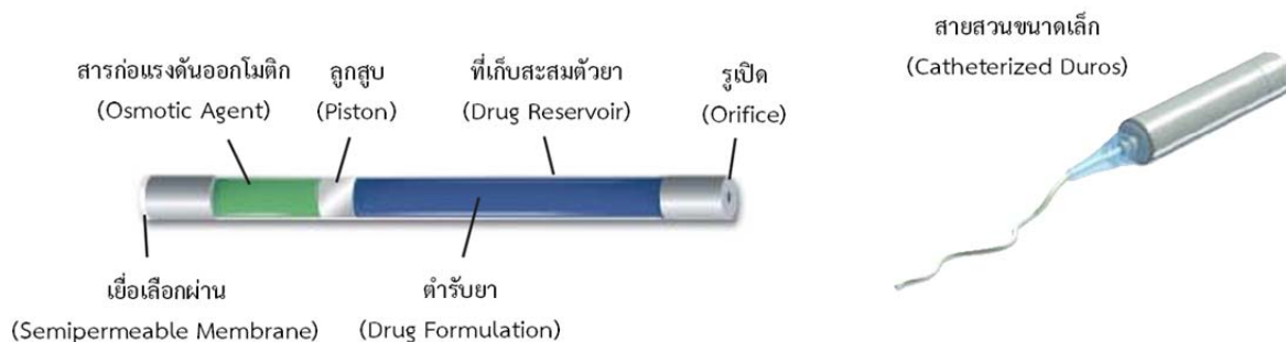
รูปที่ 1 ภาพจำลองส่วนประกอบภายในของระบบ (ก) DUROS ® system และ (ข) DUROS ® Site-specific drug delivery (DUROS ® system) และ Catheterized DUROS ® (ดัดแปลงจากเอกสารอ้างอิง (DURECT Corporation, 2015a))
