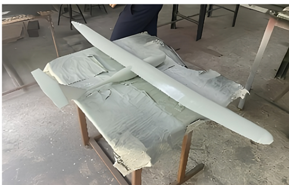
ภาพ 2 การสร้างแบบจำลอง M Solar-X พร้อมติดตั้งกับแท่นยึด (adaptor)
