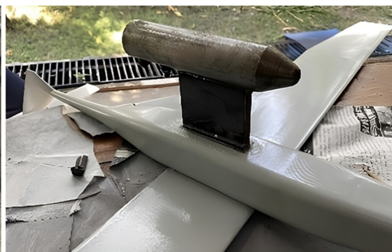
ภาพ 2 การสร้างแบบจำลอง M Solar-X พร้อมติดตั้งกับแท่นยึด (adaptor)
