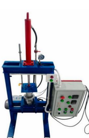
ภาพ 2 การออกแบบเครื่องอัดกระถาง
