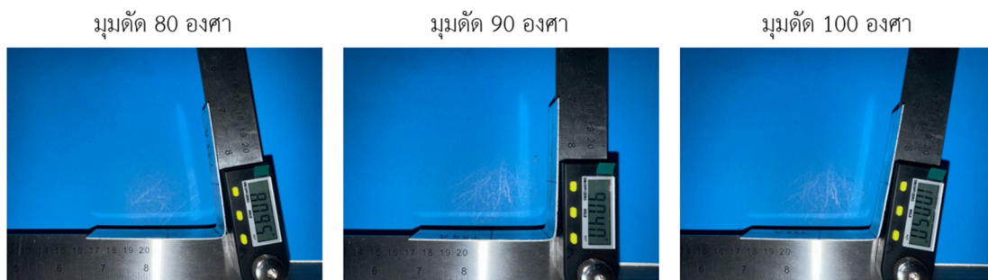
ภาพ 17 การวัดค่ามุมดัดภายหลังการขึ้นรูป
