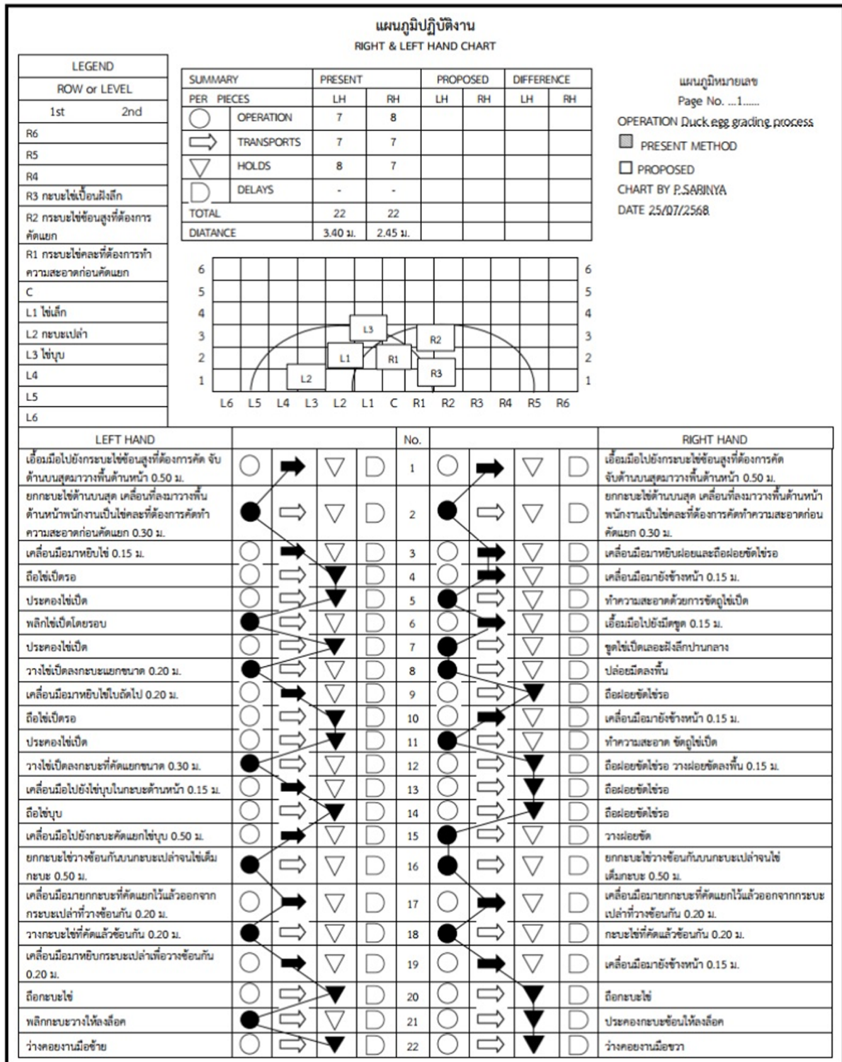
ภาพ 6 การวิเคราะห์กระบวนการคัดแยกขนาดไข่เปิดโดยใช้แผนภูมิมือซ้ายและมือขวา (ก่อนการปรับปรุง)
