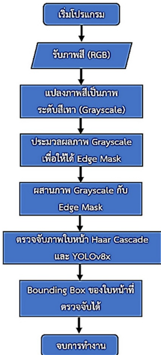
ภาพ 1 แผนผังแสดงขั้นตอนการทำงานของระบบตรวจจับใบหน้าภายใต้สภาวะแสงต่าง ๆ
