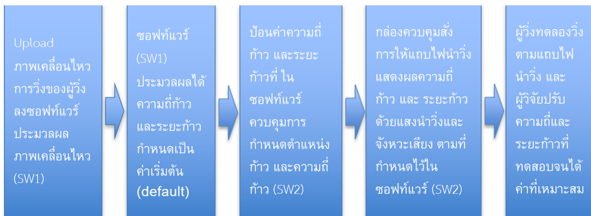
ภาพ 2 หลักการทำงานและการใช้งานของชุดอุปกรณ์กำหนดความถี่ก้าวและระยะก้าว
