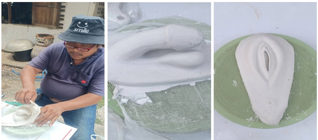
ภาพ 6 ถอดชิ้นงานปูนปลาสเตอร์จากแม่พิมพ์ซิลิโคน
