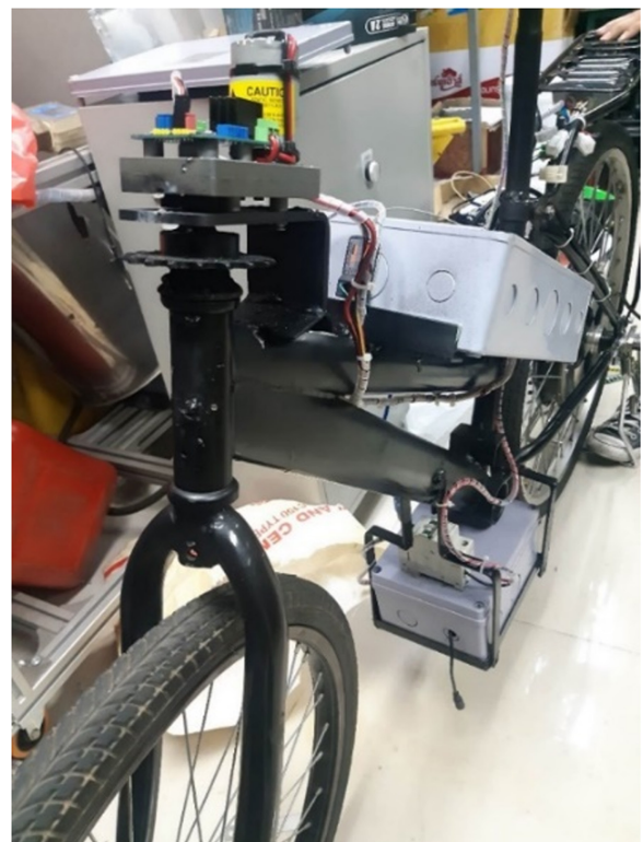
ภาพ 10 การประกอบติดตั้งมอเตอร์ชุดหน้าสำหรับบังคับเลี้ยว
