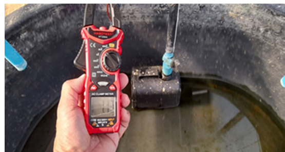
ภาพ 15 แสดงผลการทดสอบการวัดกระแสและแรงดันของปั้มน้ำ
