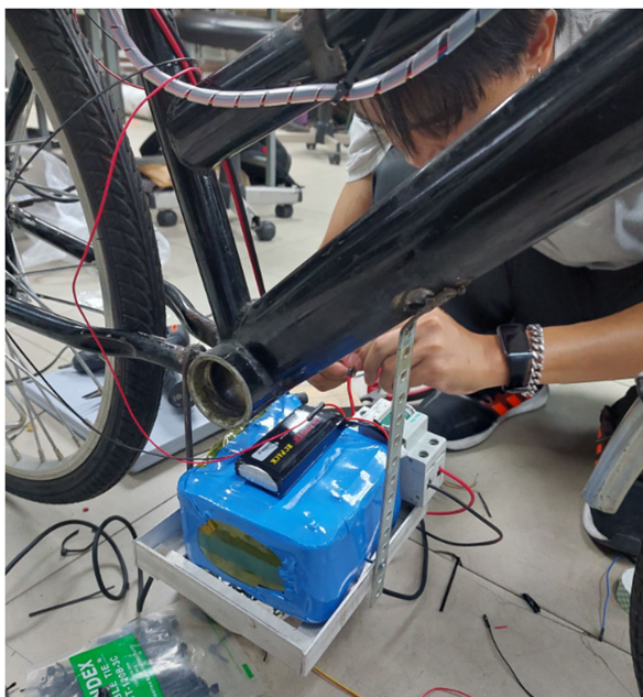
ภาพ 11 ติดตั้งแบตเตอรี่และเบรกเกอร์และนำใส่กล่องให้เรียบร้อย
