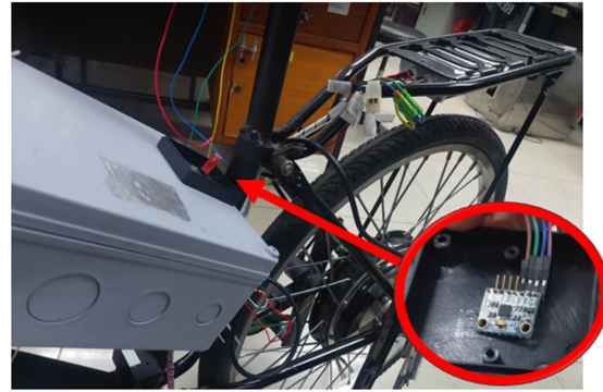
ภาพ 20 ทดลองติดตั้ง IMU จุดที่สอง
