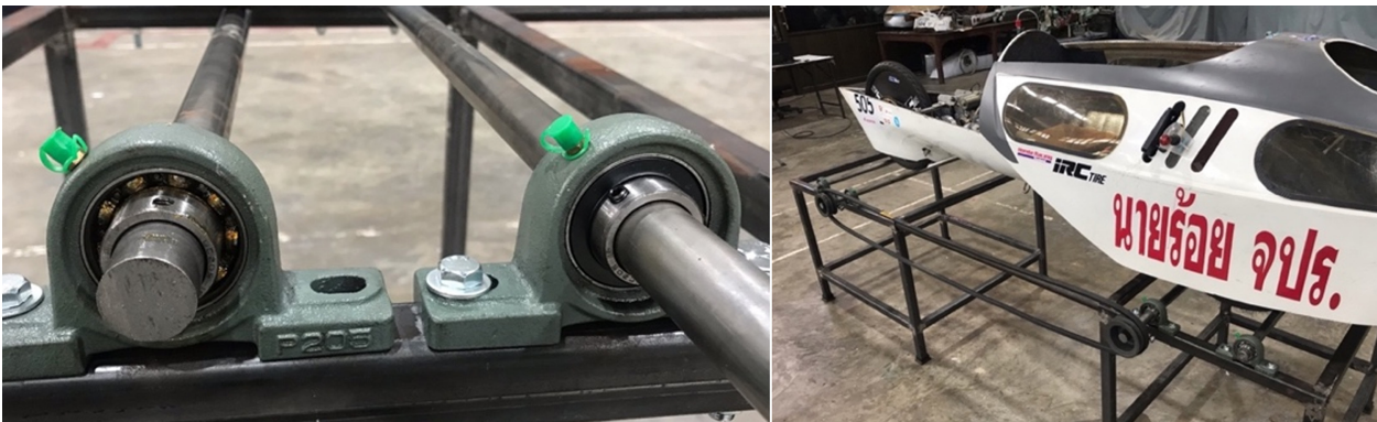
ภาพ 7 ภาพชุดขับเคลื่อนระหว่างล้อหน้ากับล้อหลัง
