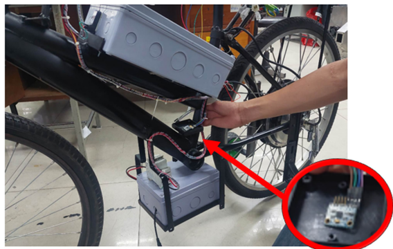
ภาพ 18 ทดลองติดตั้ง IMU จุดแรก
