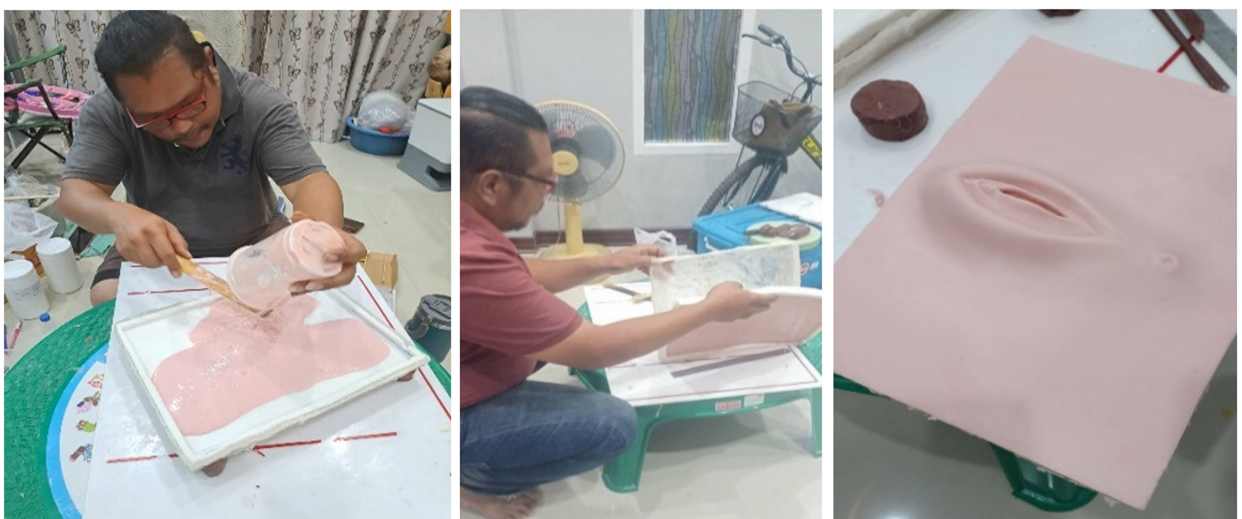
ภาพ 7 เตรียมแบบและผสมซิลิโคนตามอัตราส่วนเดิม เทลงแบบ
