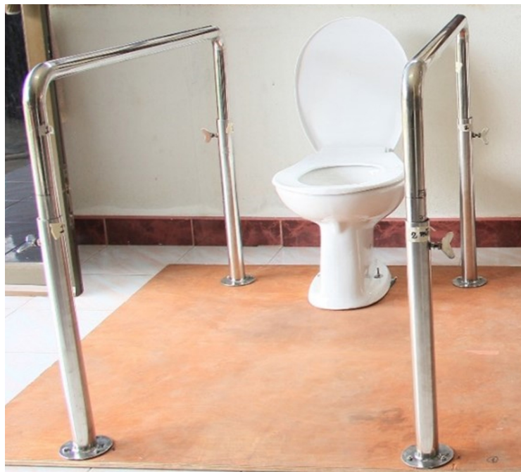
ภาพ 1 ชุดอุปกรณ์การทดลองการลุกยืนและการนั่งลงที่โถส้วมพร้อมราวจับแบบปรับความสูงได้
