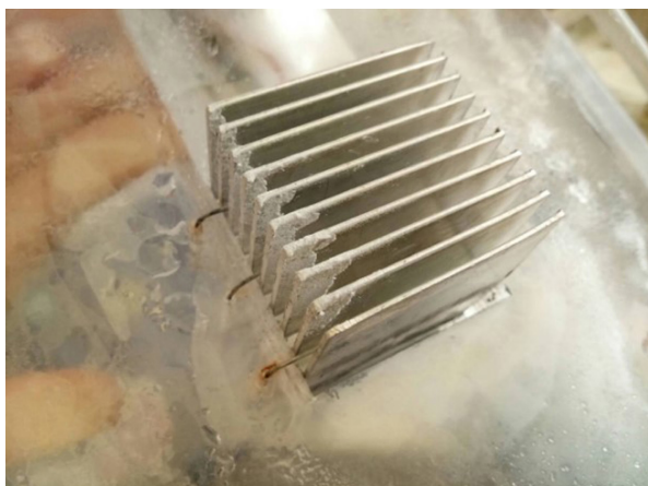
ภาพ 14 คราบเกลือที่ตกได้จากการทดลองที่ความหนา ชั้นน้ำ 3 ซม.
