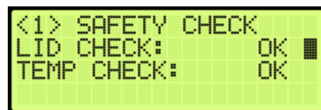
ภาพ 3 การแสดงผลของหน้าจอ LCD เริ่มระบบตรวจสอบความปลอดภัย
