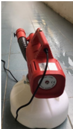
ภาพ 11 การทดสอบอัตราการพ่นน้ำมันหอมระเหย โดยใช้เครื่องพ่นไถ่ยุง
