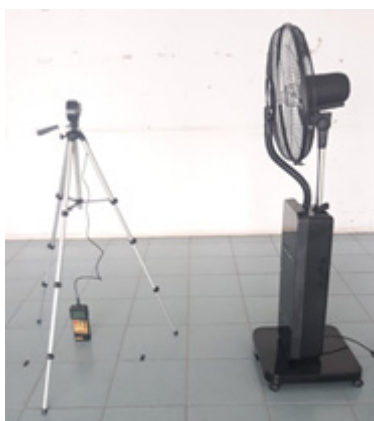
ภาพ 6 การทดสอบอัตราการระเหยน้ำมันหอมระเหย โดยใช้พัดลมที่ทำการติดตั้งอุปกรณ์กระจายน้ำยาไถ่
