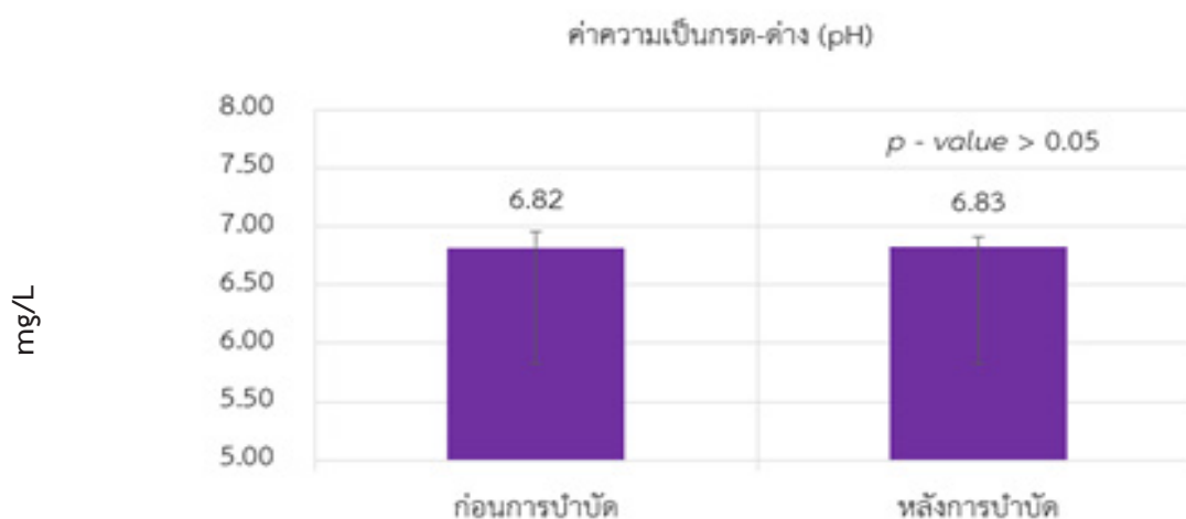
ภาพ 2 กราฟแสดงค่าความเป็นกรด-ด่างก่อนและหลังการบำบัดด้วยระบบถังปฏิกรณ์เอสปีอาร์
