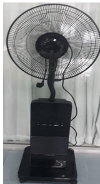
ภาพ 5 พัดลมที่ทำการติดตั้งอุปกรณ์กระจายน้ำยาไฉ่ยง
