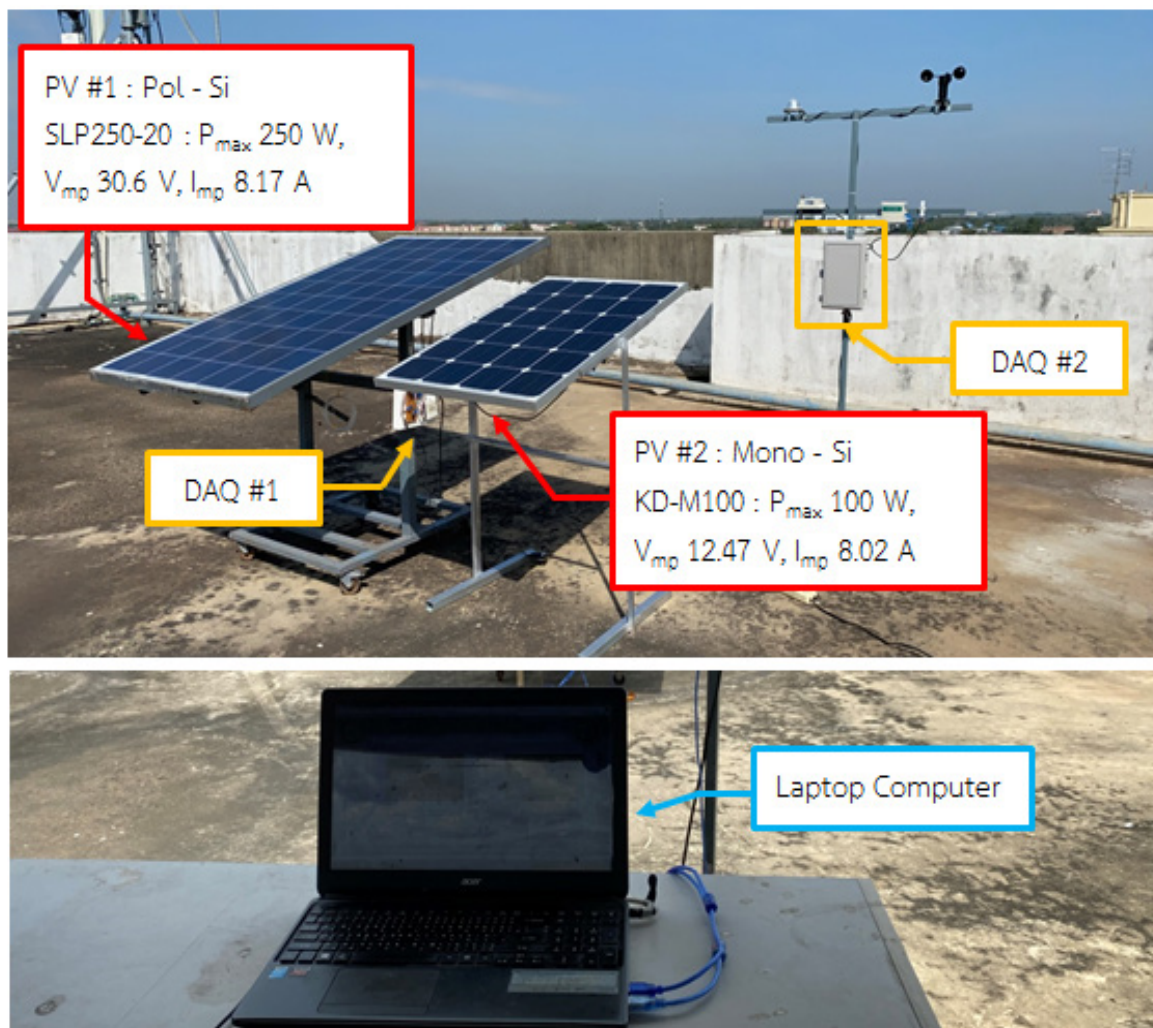
ภาพ 12 การทดสอบระบบการวัดระบบผลิตไฟฟ้าพลังงานแสงอาทิตย์เพื่อการศึกษาวิจัย
