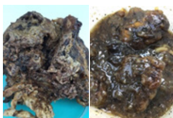
ภาพ 3 แสดงลักษณะยางก้อนถ้วยที่แช่ในสารละลาย ( \text{Na}_2\text{CO}_3 )
