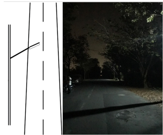
ภาพ 15 การทดสอบวัดค่าความสว่าง หลอดไฟถนนฟลูออเรสเซนต์ 2 x 36 W
