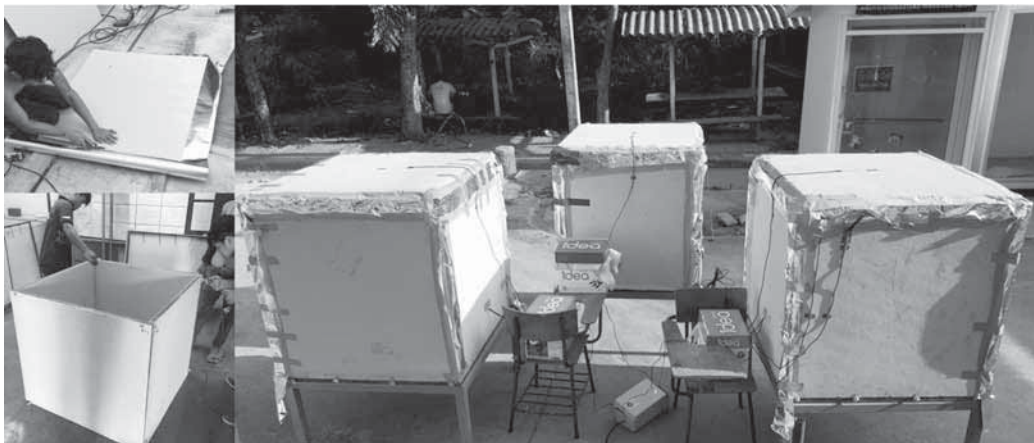
ภาพ 7 การสร้างและทดสอบกล่องตัวอย่างสำหรับการเปรียบเทียบคอนกรีตมวลเบาแบบมีรูกลวงกับคอนกรีตมวลเบาแบบปกติ
