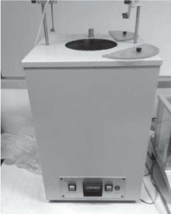
ภาพ 4 เครื่องทดสอบความร้อน Bomb Calorimeter
