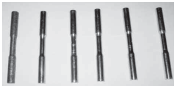
ภาพ 4 แสดงชิ้นงานเรียงจากซ้ายไปขวาเริ่มจากชิ้นงานที่ไม่ชุบนิเกิลตามด้วยชิ้นงานที่ชุบนิเกิล ที่ความหนา 10, 20, 30 และ 50 \mu\text{m} .
