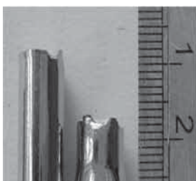
ภาพ 11 ตัวอย่างชิ้นงานที่ชุบนิกลึกความหนา 10-40 \mu\text{m} . หลังทดสอบความล้า
