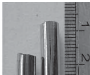
ภาพ 11 ตัวอย่างชิ้นงานที่ชุบนิกลึกความหนา 10-40 \mu\text{m} . หลังทดสอบความล้า
