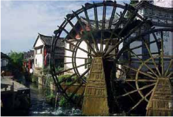
ภาพ 4 กังหันแบบเบรสต์ ที่มา. จาก กังหันแบบเบรสต์, โดย terragalleria, ค้นจาก http://www.terragalleria.com/images/china/chin
