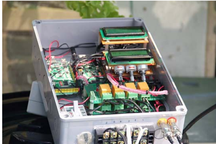
ภาพ6 ระบบควบคุมสารละลายธาตุอาหารอัตโนมัติ
