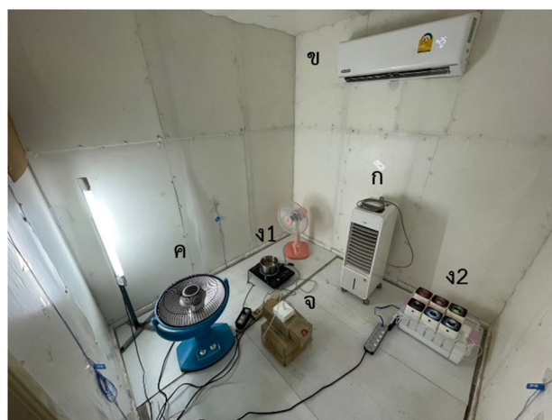
ภาพ 1 ห้องทดลองการใช้พลังงานของเครื่องปรับอากาศ (ก) ชุดลดความชื้น (ข) เครื่องปรับอากาศ (ค) ชุดสร้างภาระความร้อน (ง 1) ชุดสร้างความชื้นแบบไอน้ำ (ง 2) ชุดสร้างความชื้นแบบอัลตราโซนิก (จ) ชุดวัดอุณหภูมิและความชื้นภายในห้องทดลอง
