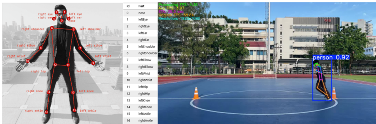
ภาพ 3 วิธีการประมวลผลภาพเคลื่อนไหวเป็นค่าความถี่ก้าวและระยะก้าว ด้วย yolov11 pose estimation และการทดสอบโปรแกรมกับภาพเคลื่อนไหวการวิ่ง
