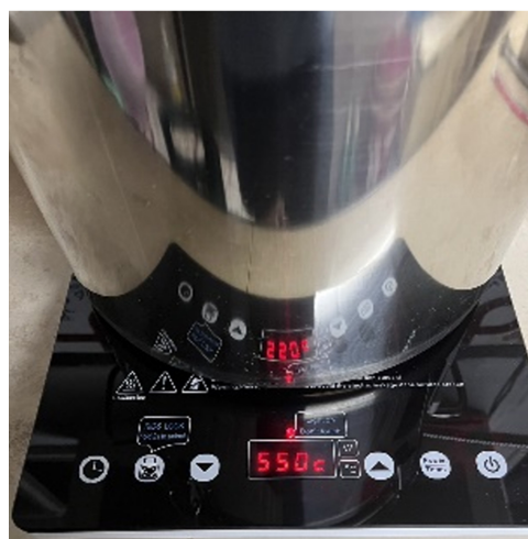
ภาพ 11 เตาแม่เหล็กไฟฟ้าปรับระดับความร้อนไว้ที่อุณหภูมิ 550°C
