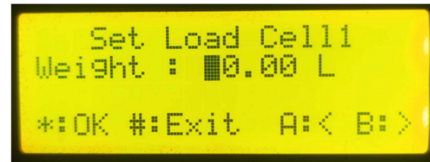
ภาพ 7 การแสดงผลของหน้าจอ LCD การวัดน้ำหนักของวัตถุดิบ
