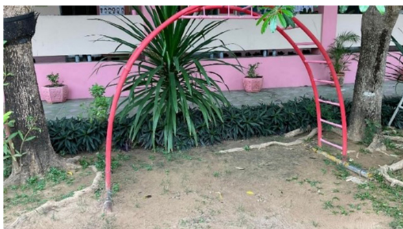
ภาพ 7 สิ่งกีดขวางภายในระยะปลอดภัยของเครื่องเล่น
