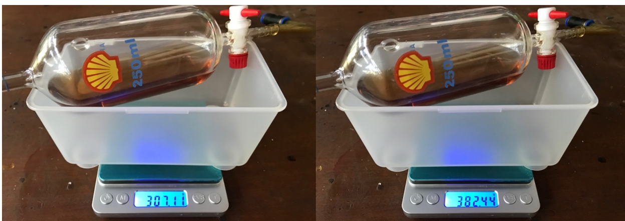
ภาพ 12 การชั่งน้ำหนักน้ำมันเชื้อเพลิงก่อนและหลังการทดสอบ
