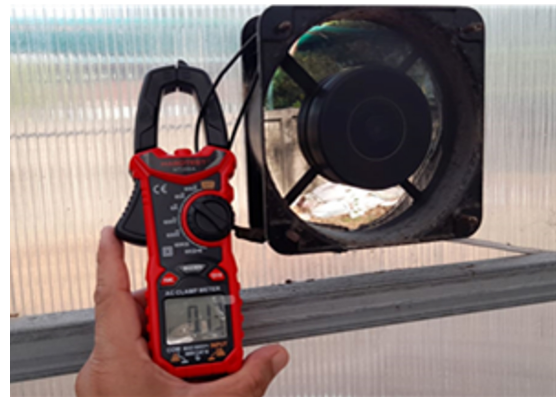
ภาพ 14 แสดงผลการทดสอบการวัดกระแสและแรงดันของพัดลมตู้ระบายความร้อน
