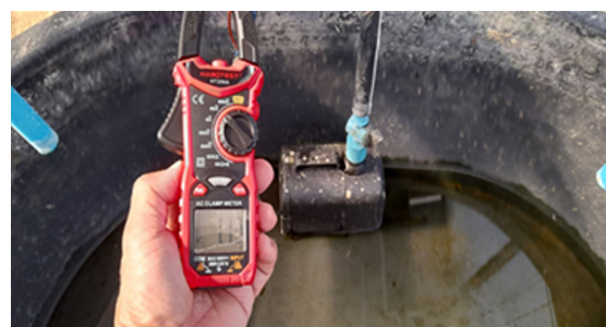
ภาพ 15 แสดงผลการทดสอบการวัดกระแสและแรงดันของปั้มน้ำ
