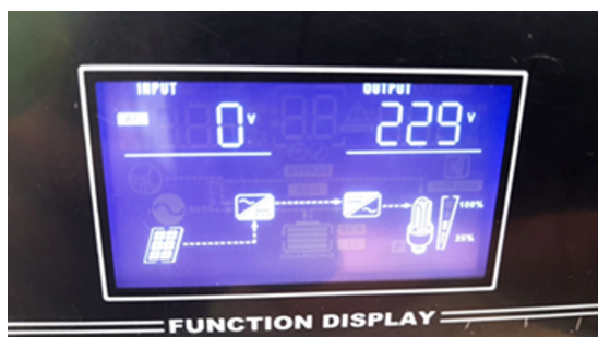
ภาพ 13 แสดงผลการทดสอบที่ Function Display
