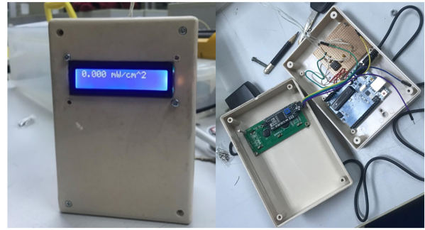
ภาพ 8 เครื่องตรวจจับการรั่วไหลของไมโครเวฟที่ออกแบบและจัดสร้างขึ้น
