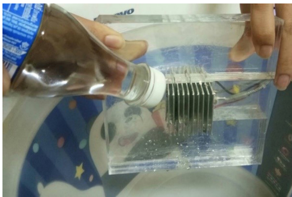
ภาพ 8 นำแผงระบายความร้อนมาล้างด้วยน้ำกลั่น
