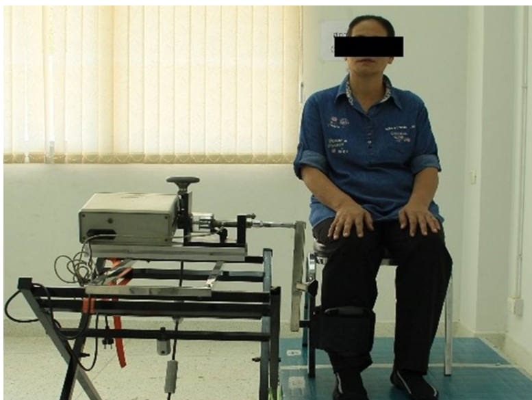
ภาพ 2 ชุดอุปกรณ์การวัดความแข็งแรงของขา
