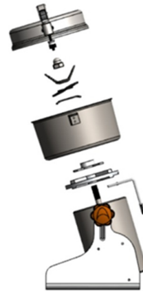
ภาพ 13 การออกแบบในส่วนเครื่องอบพร้อมบดสมุนไพร
