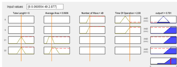
ภาพ 19 แสดง Fuzzy Rule Inference ของการวิเคราะห์การทำงานในกรณีแรงบดขั้้นแน่น
