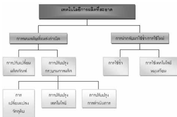
ภาพ 1 แผนผังวิธีการของเทคโนโลยีการผลิตที่สะอาด ที่มา. ดัดแปลงจาก “หลักการเทคโนโลยีสะอาด กรมควบคุมมลพิษ” (ไม่ปรากฏปี). ค้นจาก http://www.pcd.go.th
